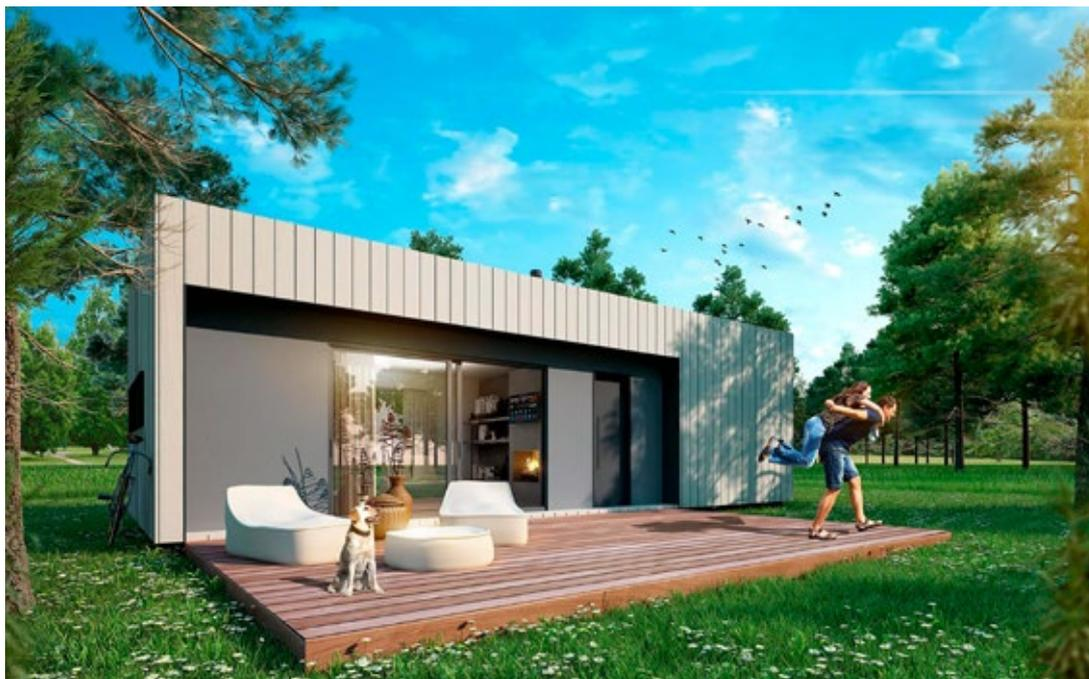
**Vivienda de un dormitorio, desarrollada en 45 m<sup>2</sup> en planta baja construida en Steel Frame. Se distinguen dos opciones como terminación exterior del sistema: SIDING y EIFS.**
